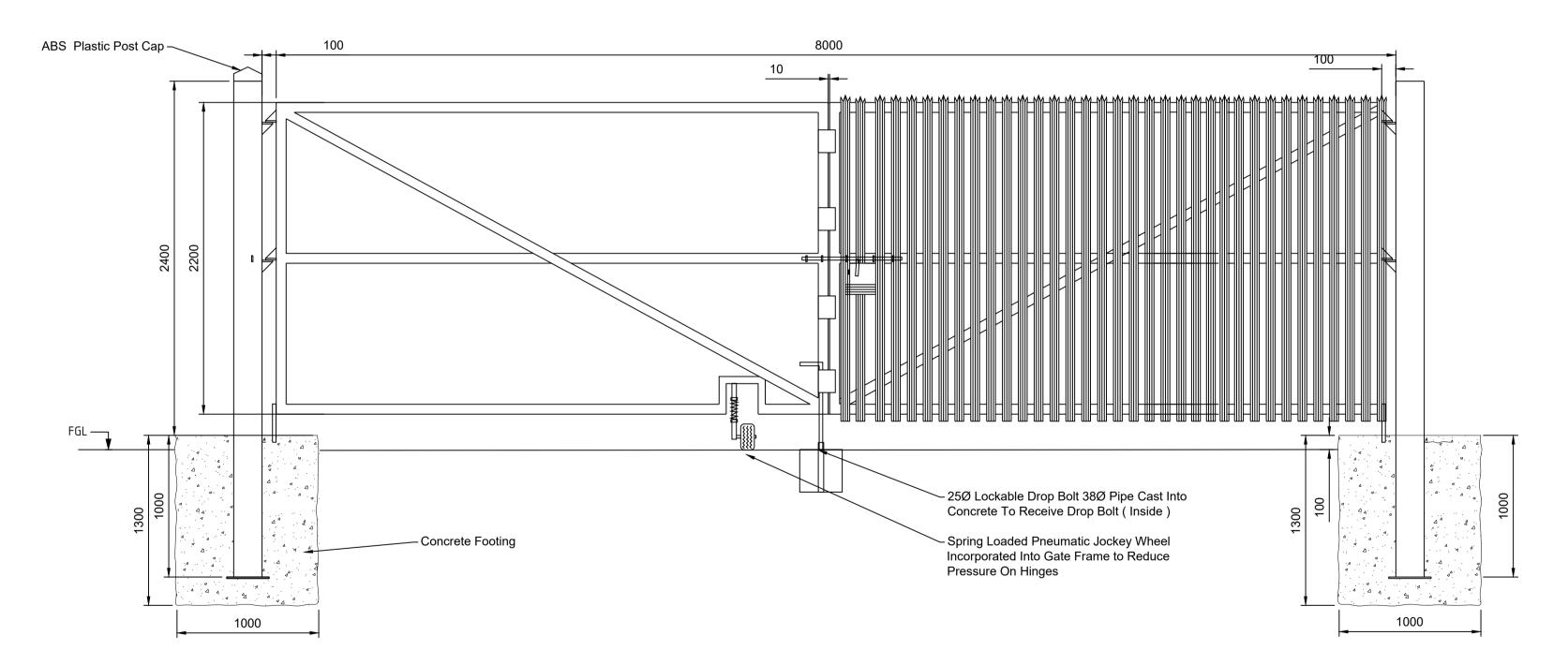
TYPICAL PALISADE GATE ELEVATION
